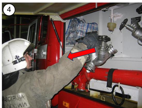
Рис. 6. Алгоритм действий по извлечению трехходового разветвления
